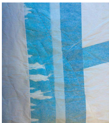
Abb. 9: Auswertung der Flächenpressung und Fuji-Film Abdruck Klebewalze Version 3.0
