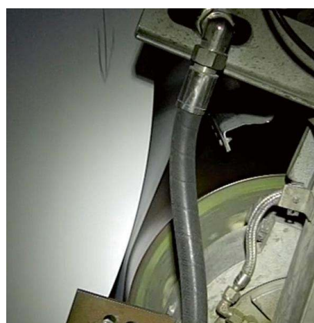
Abb. 7: Klebewalze kurz vor dem Splice-Vorgang
